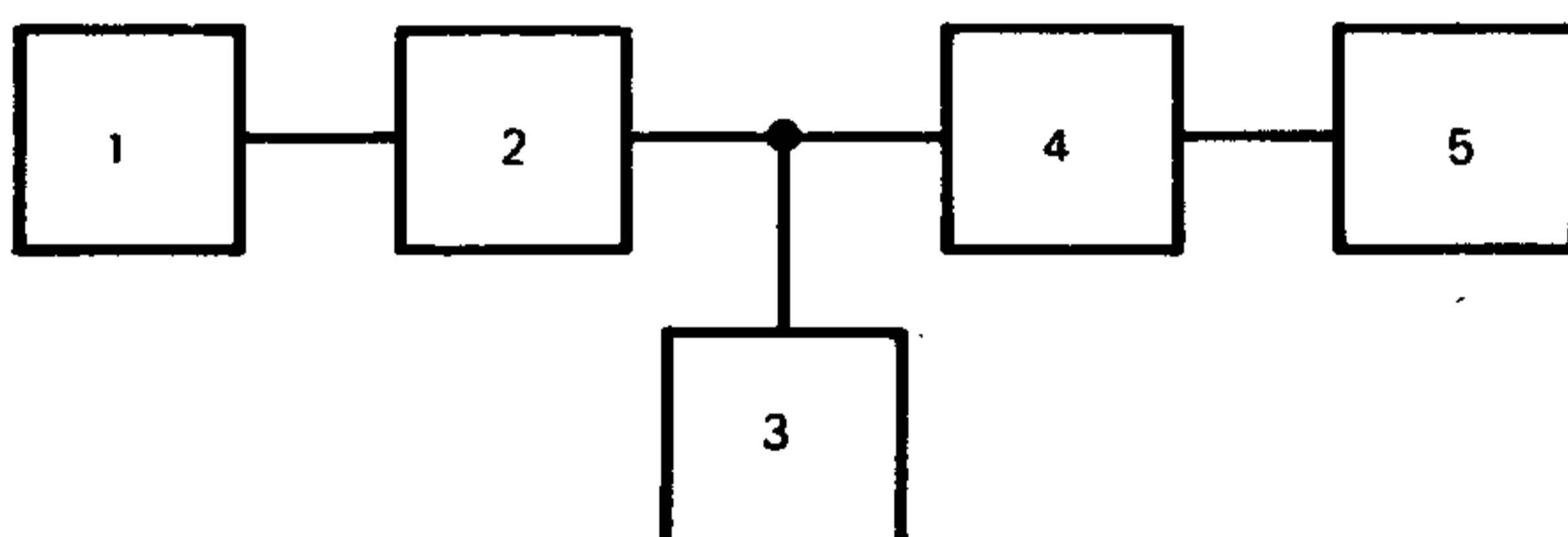
1 — измерительный компакт-диск (п. 2.2.14); 2 — измеряемый проигрыватель; 3 — эквивалент емкостной нагрузки (п. 2.2.16); 4 — фильтр нижних частот (п. 2.2.11); 5 — измеритель нелинейных искажений (п. 2.2.6)
