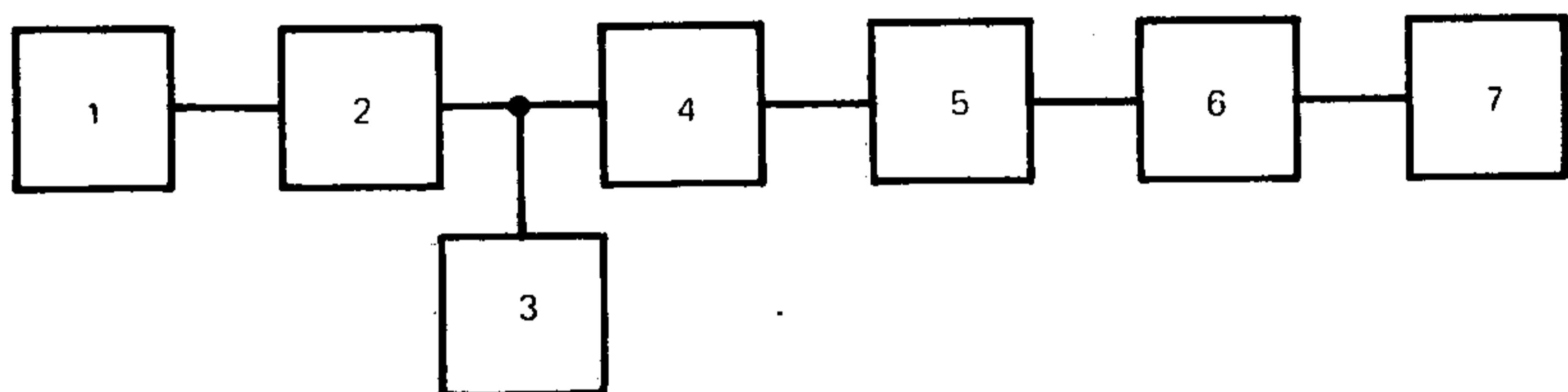
1 — измерительный компакт-диск (п. 2.2.14); 2 — измеряемый проигрыватель; 3 — эквивалент резистивно-емкостной нагрузки (п. 2.2.15); 4 — измерительный усилитель (п. 2.2.7); 5 — фильтр низких частот (п. 2.2.11); 6 — взвешивающий фильтр (п. 2.2.12); 7 — вольтметр В2 (п. 2.2.4)
