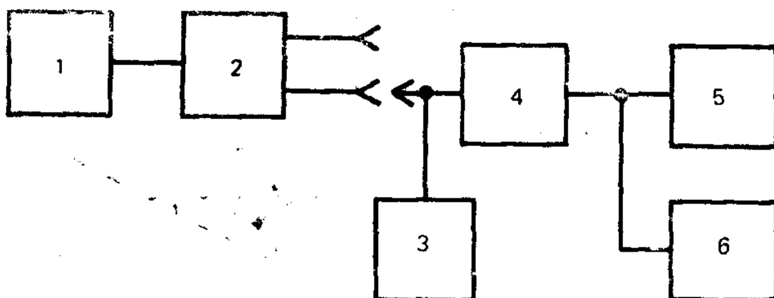
1 — измерительный компакт-диск (п. 2.2.14); 2 — измеряемый проигрыватель; 3 — эквивалент емкостной нагрузки (п. 2.2.16); 4 — фильтр нижних частот (п. 2.2.11); 5 — вольтметр В2 (п. 2.2.4); 6 — анализатор спектра (п. 2.2.5)
