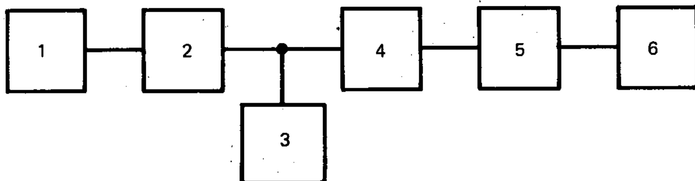
1 — измерительный компакт-диск (п. 2.2.14); 2 — измеряемый проигрыватель; 3 — эквивалент резистивно-емкостной нагрузки (п. 2.2.15); 4 — измерительный усилитель (п. 2.2.7); 5 — фильтр нижних частот (п. 2.2.11); 6 — измеритель нелинейных искажений (п. 2.2.6)
