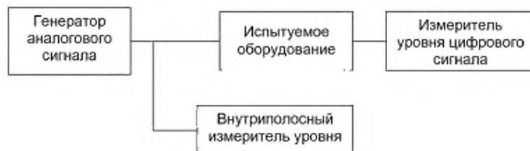
Рисунок 15 — Схема соединения оборудования
