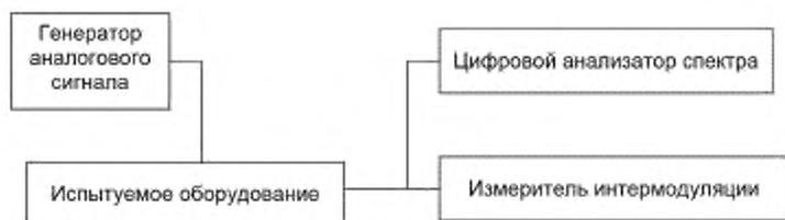
Рисунок 35 — Схема соединения оборудования
