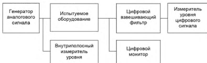
Рисунок 21 — Схема соединения оборудования
