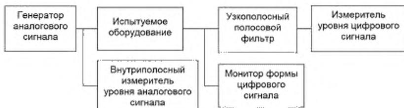
Рисунок 31 — Схема соединения оборудования
