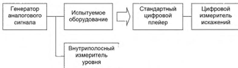
Рисунок 34 — Схема соединения оборудования
