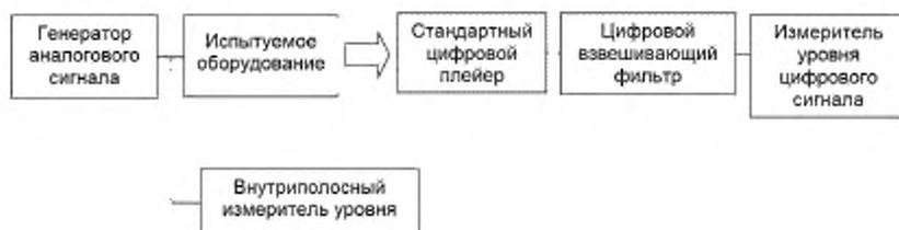
Рисунок 22 — Схема соединения оборудования
