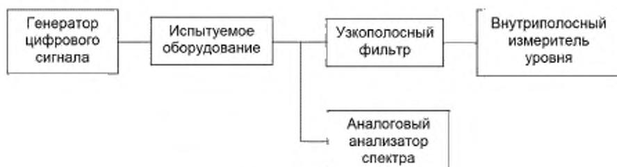
Рисунок 7 — Схема соединения оборудования
