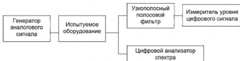
Рисунок 29 — Схема соединения оборудования
