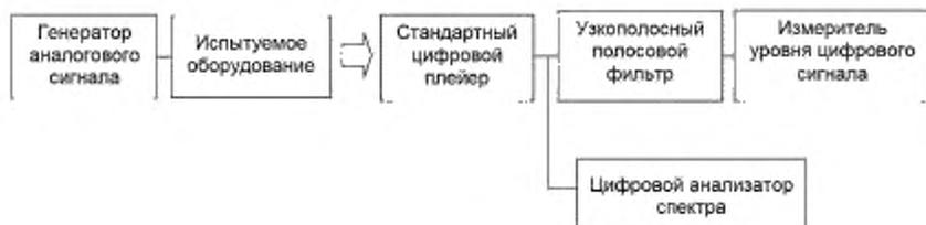
Рисунок 30 — Схема соединения оборудования
