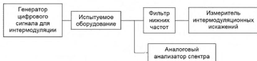
Рисунок 10 — Схема соединения оборудования
