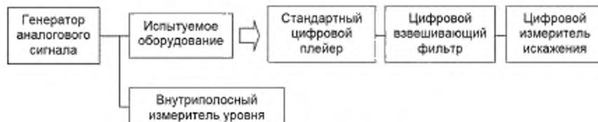
Рисунок 24 — Схема соединения оборудования
