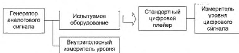
Рисунок 26 — Схема соединения оборудования
