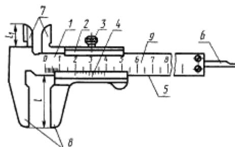
1 — штанга; 2 — рамка; 3 — зажимающий элемент; 4 — нониус; 5 — рабочая поверхность штанги; 6 — глубиномер; 7 — губки с кромочными измерительными поверхностями для измерения внутренних размеров; 8 — губки с плоскими измерительными поверхностями для измерения наружных размеров; 9 — шкала штанги
