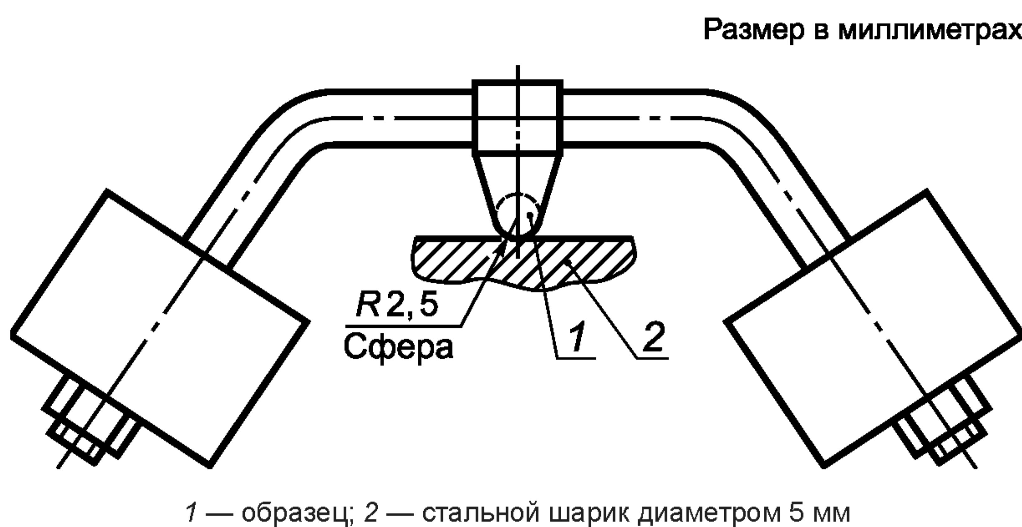
Рисунок 25 — Установка для испытания прочности материалов
