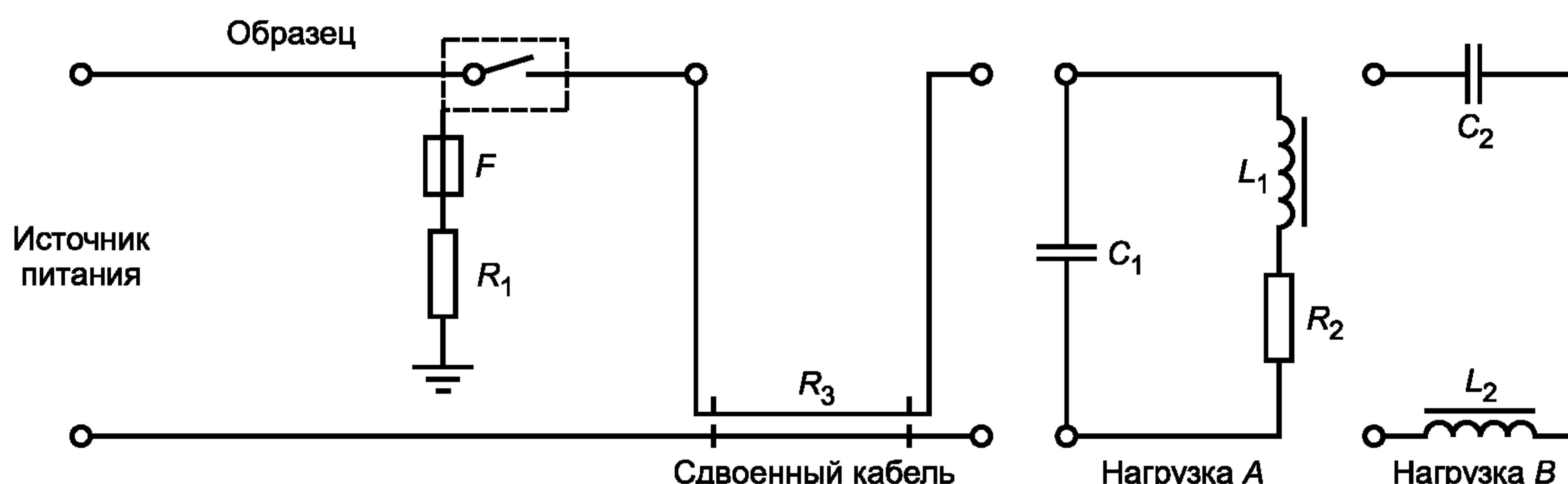
Рисунок 14 — Принципиальная схема для испытаний выключателей для люминесцентных ламп под нагрузкой
