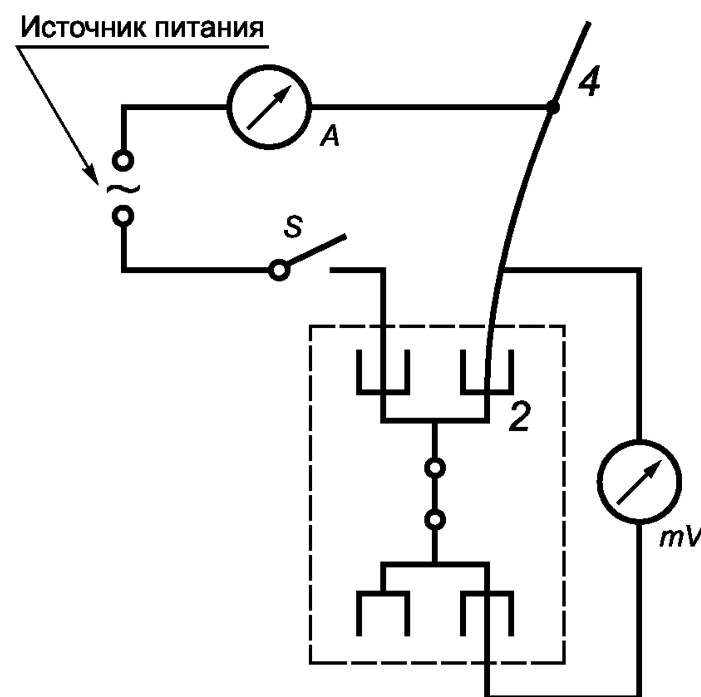
*A* — амперметр; *S* — выключатель; *mV* — милливольтметр; 1 — образец; 2 — испытуемое прижимное устройство; 3 — проводник; 4 — прогнутый проводник; 5 — точка приложения усилия для прогиба проводника; 6 — направление отклоняющей силы (перпендикулярно к неотклоненному проводу)
