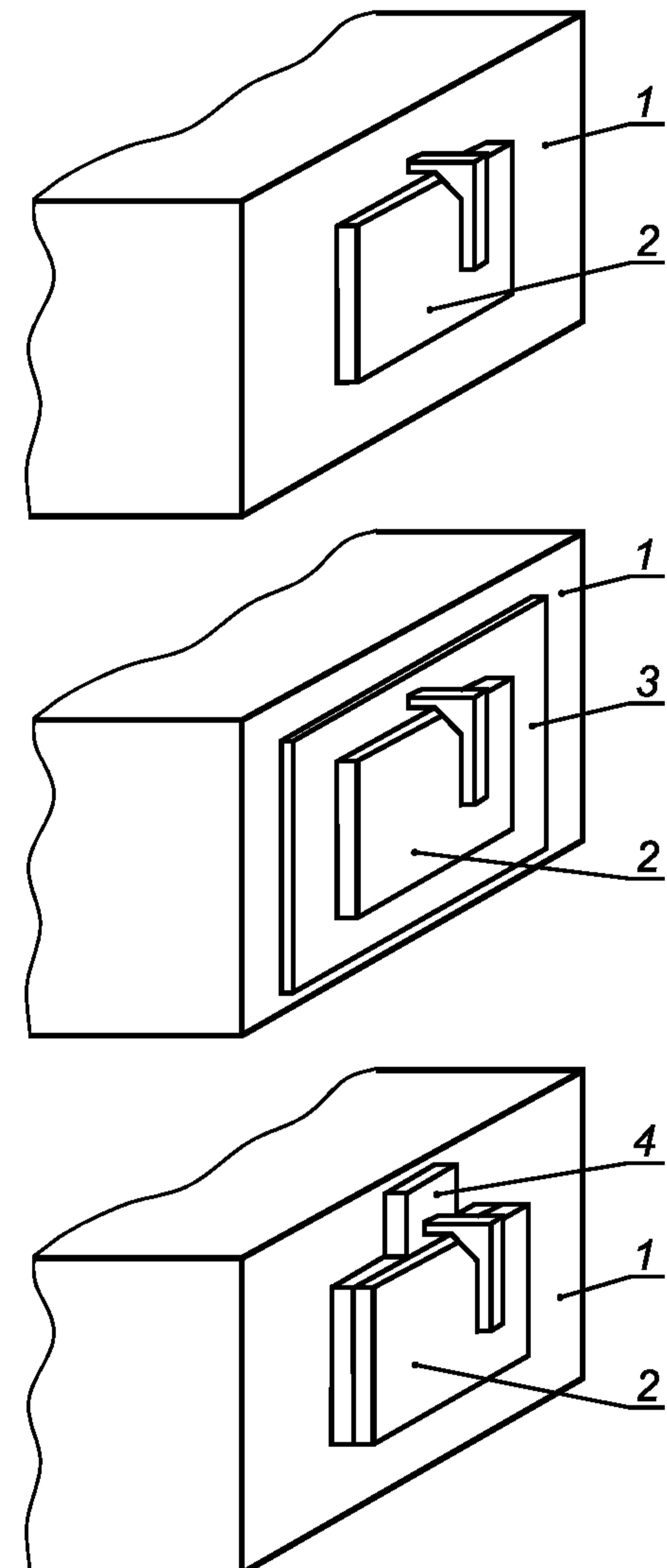
1 — монтажная поверхность; 2 — выключатель; 3 — опора;
