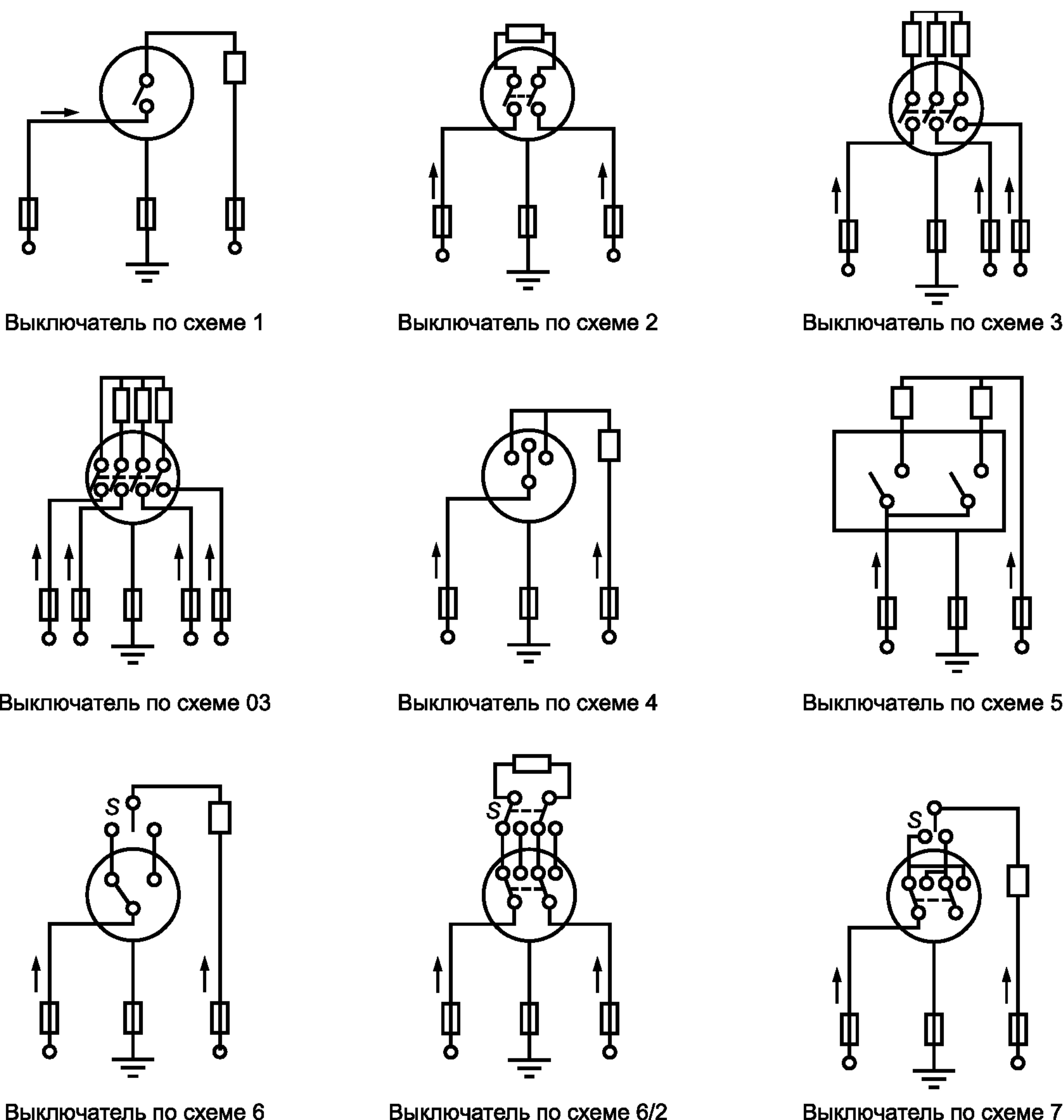
Стрелки, показывающие соединение фазных проводников, приведены исключительно в качестве примера.
