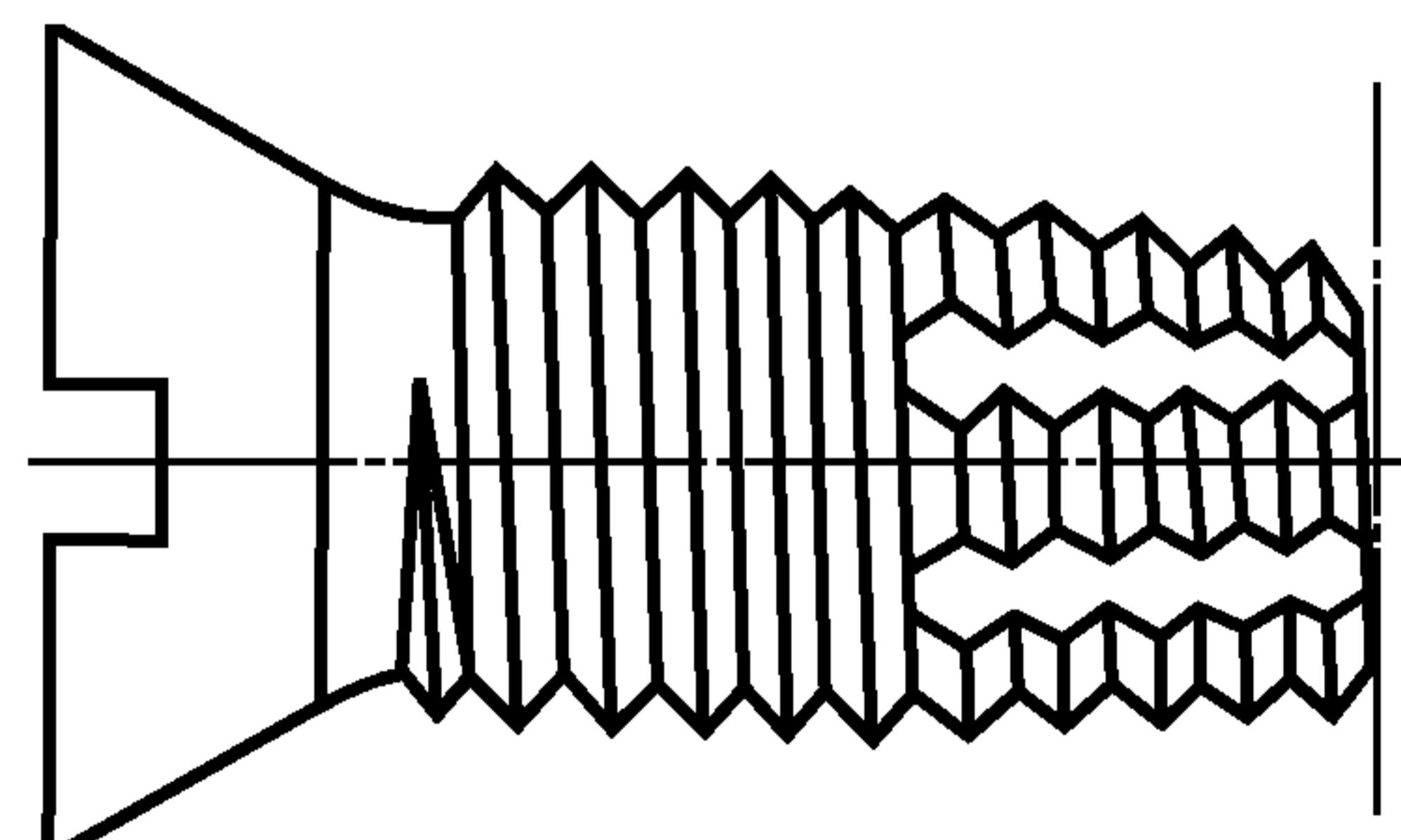
Рисунок 7 — Самонарезающий режущий винт
