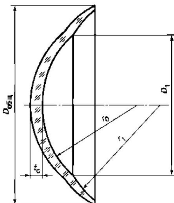
Рисунок 1 — Общий вид сферических линз с двухкривизновой поверхностью
